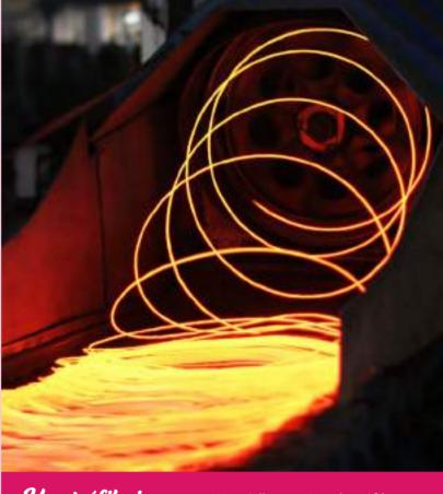
Une tréfilerie est une usine où l'on pratique le tréfilage, l'étirage du fer en fil. Le filiériste travaille le métal à chaud ou à froid jusqu'à l'obtention de pièces ou ébauches de pièces aux formes et dimensions définies.
